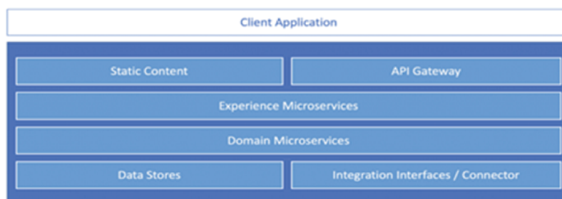
Рис. 1. Структура мікросервісного застосунку
